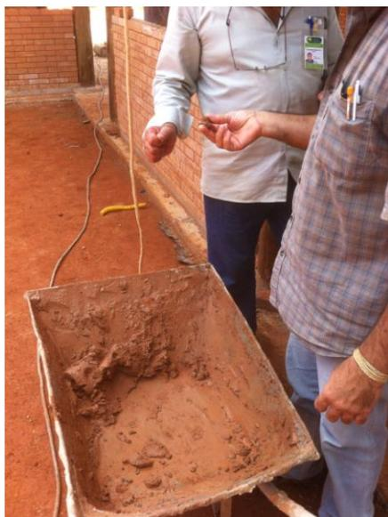
Figura 11: Ensaio empírico do solo para taipa de mão
